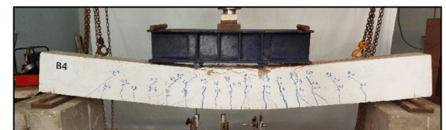
(d) Crack Patterns for the Tested Beam B4
